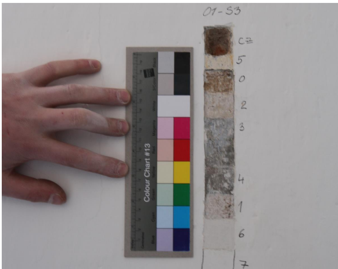
Sonda S3- v ploše stěny: CZ- cihelné zdivo, 0- omítka, 1- bílý nátěr, 2- šedá, 3- světle modrá, 4- šedá s fragmenty černé, 5- světle žlutá s fragmenty okru, 6- bílá, 7- současný bílý nátěr
