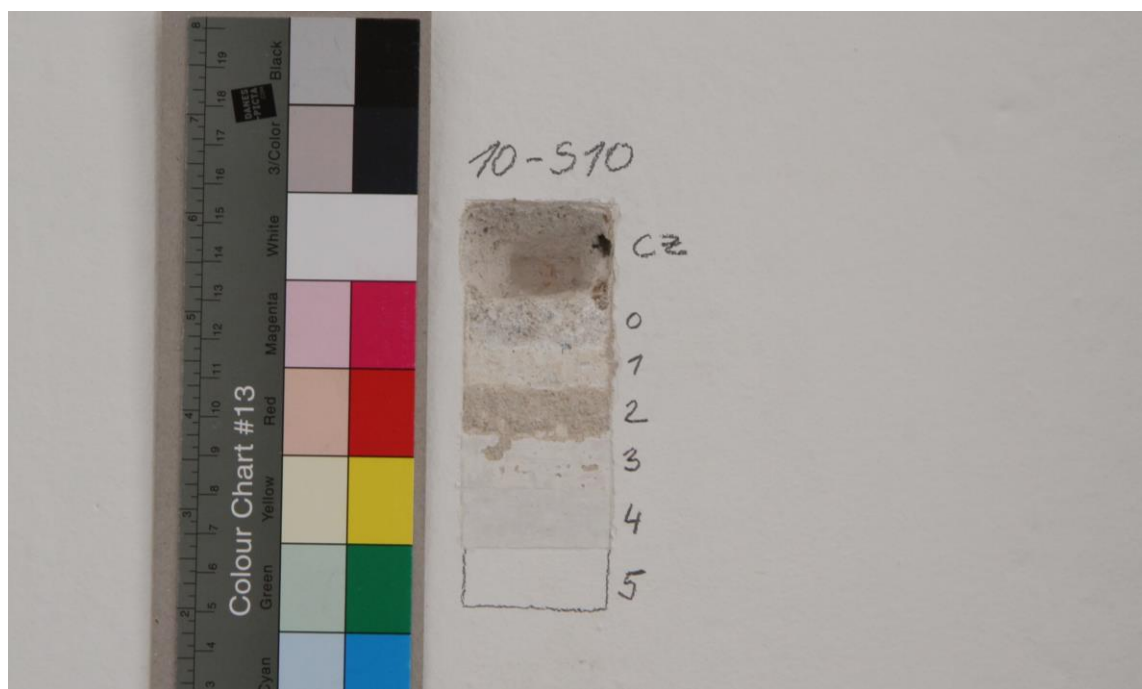
Sonda S10 v ploše stěny: CZ- cihelné zdivo, 0- omítka, bílý nátěr s fragmenty šedomodré, 1- bílá, 2- štuk, 3- bílá, 4- světle šedá, 5- současný bílý nátěr
