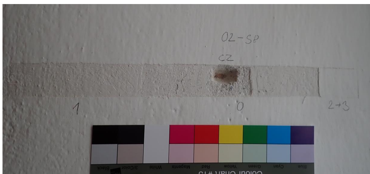
Sonda S8- v okenním ostění: CZ- cihelné zdivo, 0- omítka, 1- bílý nátěr, 2- bílá, 3- současný bílý nátěr
