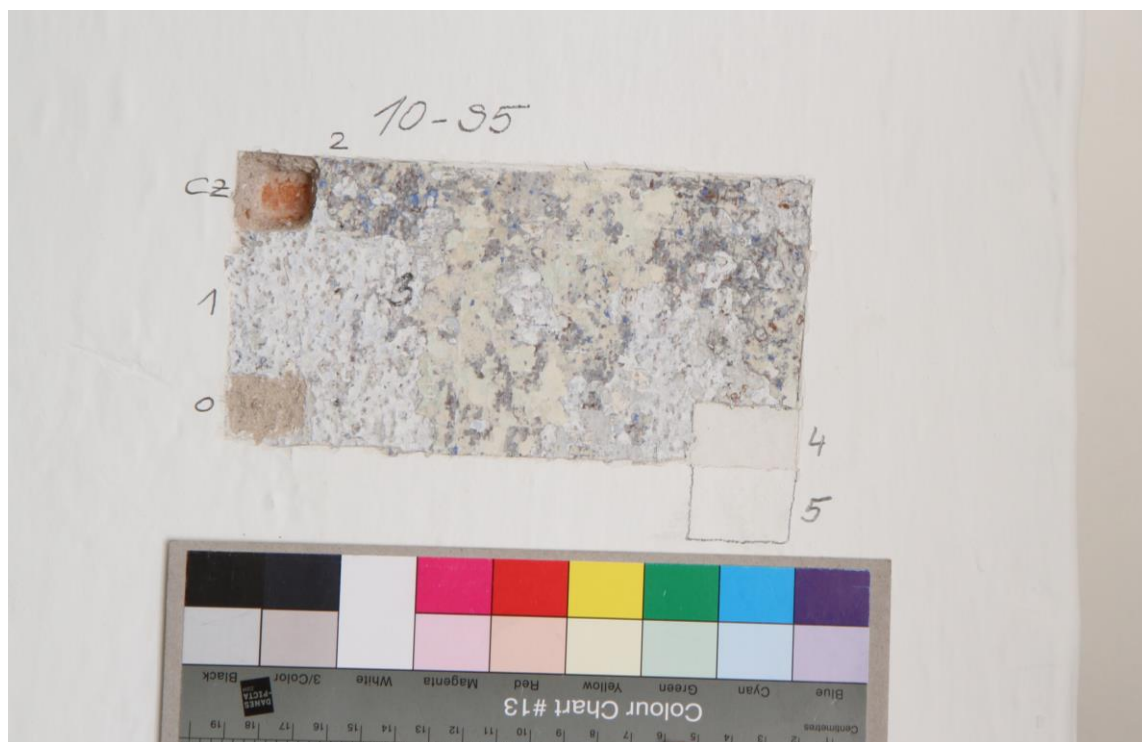
Sonda S5 v ploše stěny: CZ- cihelné zdivo, 0- omítka, 1- bílý nátěr s fragmenty šedé, 2- fragmenty bílé, hnědé a modré, 3- světle žlutá s fragmenty světle zelené, 4- bílá, 5- současný bílý nátěr
