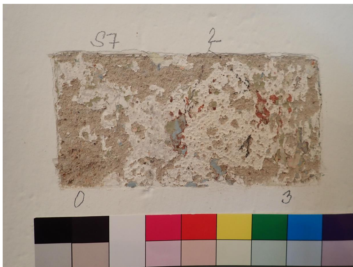
Sonda S7 v ploše stěny: 0- omítka, 1- bílý nátěr, 2- fragmenty šedé, červené, zelené, modré, oranžové, 3- současný bílý nátěr
